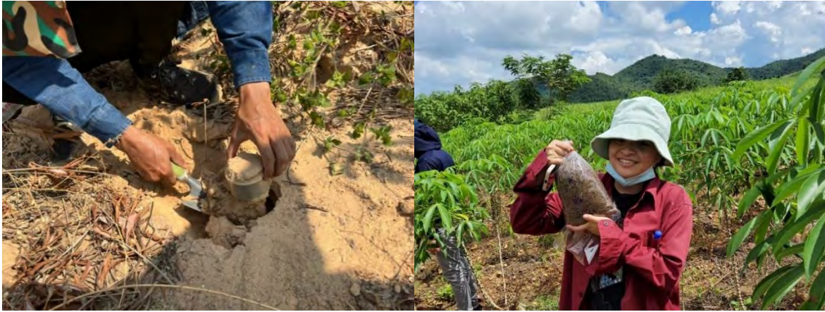
ภาพภาคผนวกที่ 3 เก็บตัวอย่างดินแบบไม่รบกวนโครงสร้างด้วย soil core และเก็บตัวอย่างดินแบบรบกวนโครงสร้างเพื่อนำมาวิเคราะห์สมบัติทางกายภาพและสมบัติทางเคมีเพื่อประเมินค่า K-Factor ในห้องปฏิบัติการ
